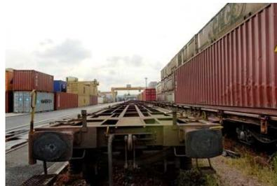
**Le système « Polyrail »** : transbordement latéral de caisses adaptées, entre un wagon et un véhicule routier spécifique. Le camion plateau, équipé d'un transbordeur, se positionne à côté du wagon. Temps de transbordement moyen du conteneur : 8 min.
