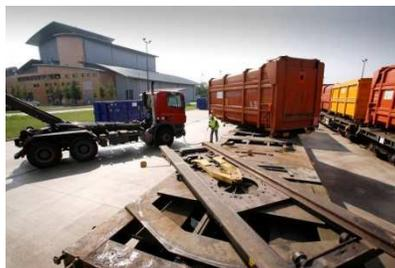
**Le système « multi-berces »** : wagon plat spécifique équipé de 3 cadres pivotants qui supportent des conteneurs polyvalents rail-route de type « ampliroll ». Les conteneurs sont déposés sur les cadres par un camion standard équipé d'un bras de levage hydraulique.
