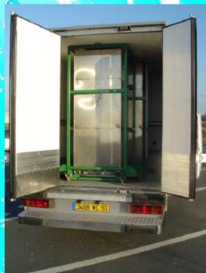
*Véhicule équipé à la fois d'un système de froid et de chaud pour maintenir une température constante entre 15°C et 20°C*
