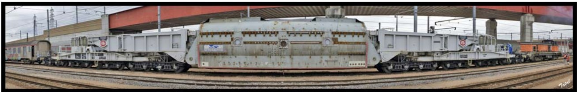
Figure 21 : wagon « à bec » (Crédits : Photos-de-trains.net)
