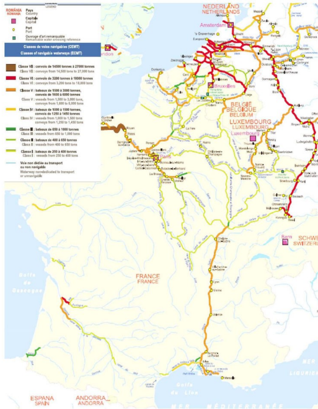
Figure 24 : capacités du réseau fluvial français (Crédits : VNF)
