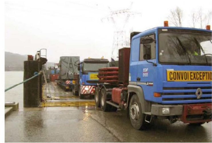
Figure 27 : illustration de la technique Ro-Ro en transport exceptionnel (Crédits : Sétral (EDF))
